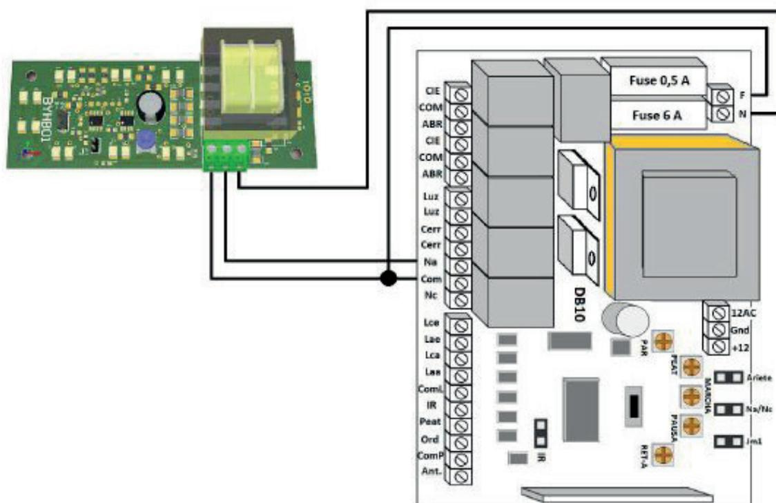
Esquema 4 - Conexión de Baliza de 3 Cables
