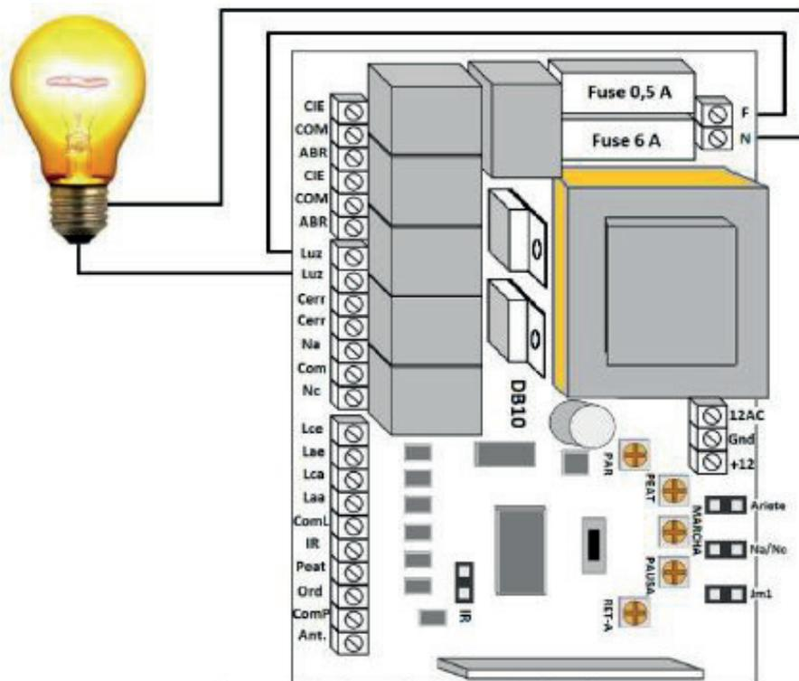
Esquema 3 - Conexión de Luz de Cortesía
