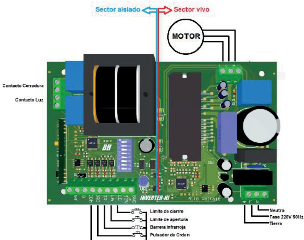
Las borneras "Contacto Luz" y "Contacto Cerradura" son contactos de relé, no entrega ningún tipo de tensión.
